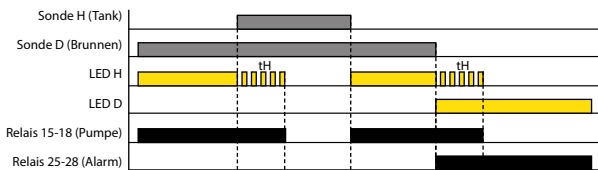
BRUNNEN - TANK, VERZÖGERUNG AUS (Funktion 7)
