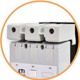
→ Zusätzliche TBE-Klemmen ermöglichen den gleichzeitigen Anschluss nicht nur von ein- und mehrdrähtigen Leitern, sondern auch von Leitern unterschiedlicher Querschnitte.
