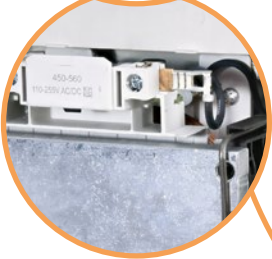
→ eingebauter Varistor (EMV-Filter)
